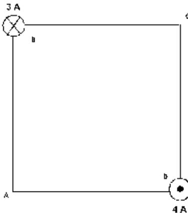
(97-E) Dos hilos metálicos largos y paralelos, por los que circulan corrientes de 3 A y 4 A, pasan por los vértices B y D de un cuadrado de 2 m de lado, situado en un plano perpendicular, como se ilustra en la figura. El sentido de las corrientes se indica por los símbolos  $\times$  = entra en el papel,  $\bullet$  = sale del papel.
