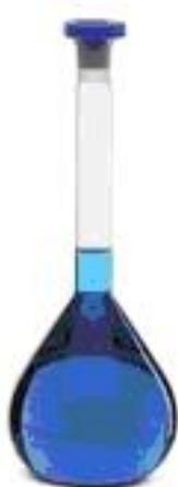
**MATRAZ AFORADO:** Recipiente de vidrio que mide volúmenes con gran precisión. Sólo tiene un aforo por lo tanto solamente puede medir un volumen. No se pueden calentar ni echar líquidos calientes, ya que están calibrados para una determinada temperatura. El enrase debe hacerse con sumo cuidado, dejando la parte baja del menisco tangente a la señal del aforo.
