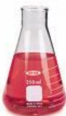
**MATRAZ ERLLENMEYER:** Matraz de vidrio de forma cónica de base ancha y cuello estrecho. En él se pueden preparar disoluciones, calentarlas etc. Es resistente al calor, aunque sólo debe calentarse usando una rejilla. Las graduaciones que tiene son aproximadas y sólo nos pueden servir como orientación.
