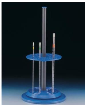
**SOPORTE PARA PIPETAS:** Instrumento que sirve para depositar y guardar las pipetas. Consta de dos bases con agujeros de distintos grosores que sirven para almacenar las pipetas después de su uso.
