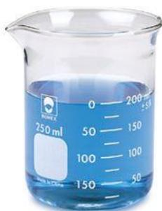
**VASOS DE PRECIPITADO:** Recipiente de vidrio muy utilizado en el laboratorio para múltiples usos. Sirve para todo, preparar una disolución, de depósito, etc. Se puede calentar, aunque nunca directamente a la llama, sino mediante una rejilla de amianto. Pueden ser altos o bajos y el volumen que indican es aproximado, nunca con precisión, por lo tanto no puede ser utilizado para la medida de volúmenes.
