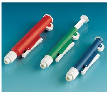
**ÉMBOLO LLENA-PIPETAS:** Instrumento utilizado para llenar pipetas, al igual que la pera llena-pipetas.
