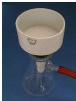
El papel de filtro debe tener un diámetro ligeramente inferior al del embudo, de forma que tape los orificios pero no suba por las paredes del embudo.
