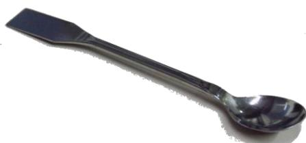
**ESPÁTULA CUCHARA:** Es un utensilio de acero inoxidable que se utiliza para tomar muestras de compuestos y recoger elementos en estado sólido para transferirlos de un recipiente a otro. Por un extremo presenta una espátula plana y por el otro extremo tiene forma de cuchara.
