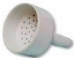
**EMBUDO BUCHNER:** Instrumento de porcelana que lleva una placa filtrante con agujeros grandes sobre el que se coloca un trozo de papel de filtro. Se emplea para filtrar por succión al vacío.
