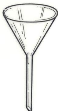
**EMBUDO DE VIDRIO:** Instrumento de vidrio que se emplea para trasvasar líquidos o disoluciones de un matraz a otro.
