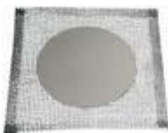
**REJILLAS DE AMIANTO:** Tela metálica con una zona circular de amianto. Se pone entre la llama del mechero y el material de vidrio a calentar. Se coloca sobre un soporte o trípode para que el calor llegue uniformemente a toda la superficie del recipiente de vidrio que se quiere calentar.
