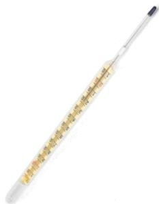
**TERMÓMETRO:** Aparato de vidrio que sirve para medir la temperatura. Hay que usar siempre un termómetro que pueda marcar una temperatura superior a la que se encuentra lo que se quiera medir. Para medir la temperatura hay que dejar el termómetro en contacto con lo que se quiera medir durante unos minutos y se ha de hacer la lectura con el bulbo del termómetro en contacto con lo que se está midiendo. Nunca se debe utilizar como agitador.
