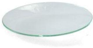
**VIDRIO DE RELOJ:** Lámina de vidrio cóncavo-convexa que se emplea para pesar los sólidos y como recipiente para recoger un precipitado sólido de cualquier experiencia que se introducirá en un desecador o bien en una estufa.
