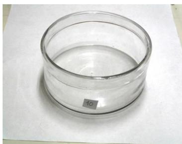
**CRISTALIZADOR:** Recipiente de vidrio de base ancha y poca altura en el que se echa una disolución (ésta puede estar caliente) para que precipite el soluto y por efecto del reposo y demás condiciones conseguir que cristalice. El objetivo de la forma es que tenga una base ancha para permitir una mayor evaporación de sustancias. Nunca deben ser calentados.
